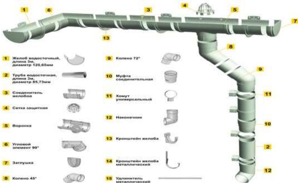
1 Желоб водосточный, длина 3м, диаметр 120,65мм
